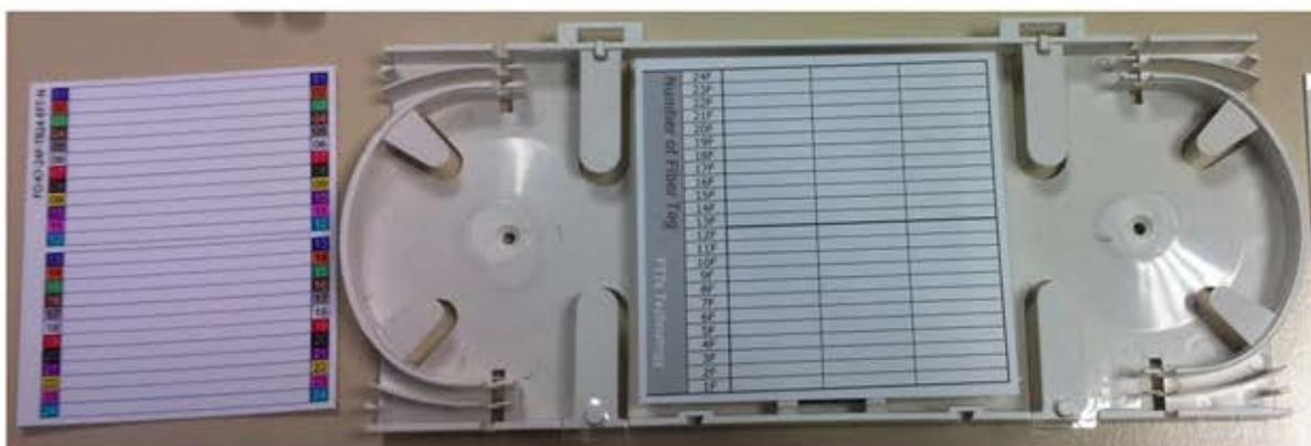
La cassette de fusion fournie permet de maintenir les pigtails et câbles en entrée de cassette grâce aux bouchons de mousse. Elle peut contenir jusqu'à 24 brins et permet le lovage des sur-longueurs et le soutien des protections d'épissures après la fusion. Les cassettes sont empilables les unes sur les autres à hauteur de 2 cassettes. Il y a 2 cassettes par tiroir ELE48001-H fixées par velcro adhésif.
